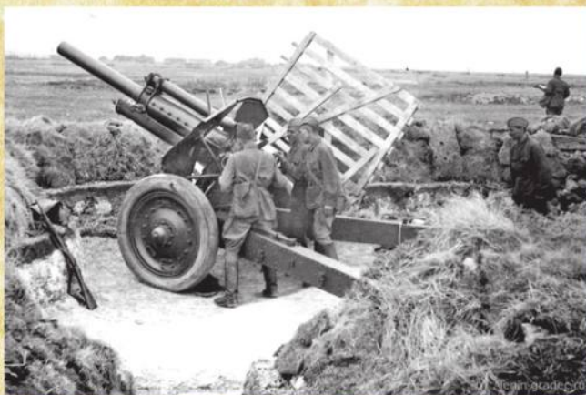
Советская 122-мм гаубица периода Второй мировой войны. Этим орудием были вооружены первые советские крупносерийные самоходные артиллерийские установки Великой Отечественной войны СУ-122. Оснащение артиллерии Рабоче-крестьянской Красной армии гаубицами М-30 сыграло большую роль в разгроме нацистской Германии в Великой Отечественной войне.
